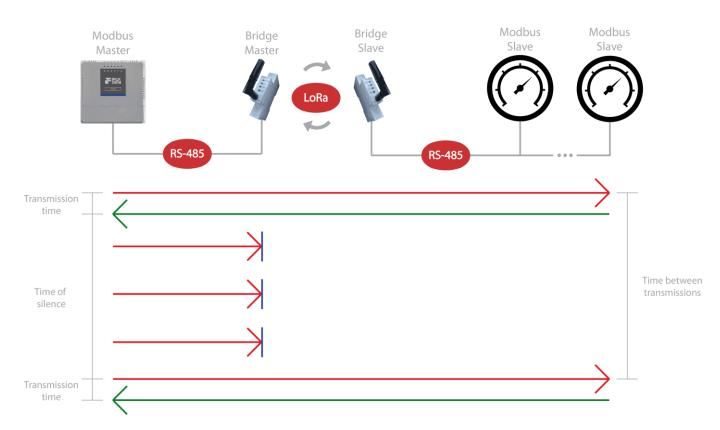
En base a dichos tiempos, se establecen 2 reglas de comunicación que **deben aplicarse en el Master Modbus de la instalación.** La primera de ellas, descrita a continuación, es **completamente esencial** para establecer comunicación inalámbrica con los esclavos Modbus a través de una red inalámbrica Bridge LR:
